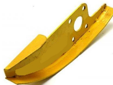
Рисунок 11 – Регулируемые опорные лыжи навесного мульчера
