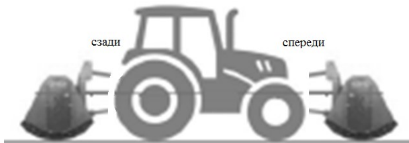
Рисунок 2 – Способ агрегатирования мульчера навесной конструкции роторного измельчения для удаления растительности
