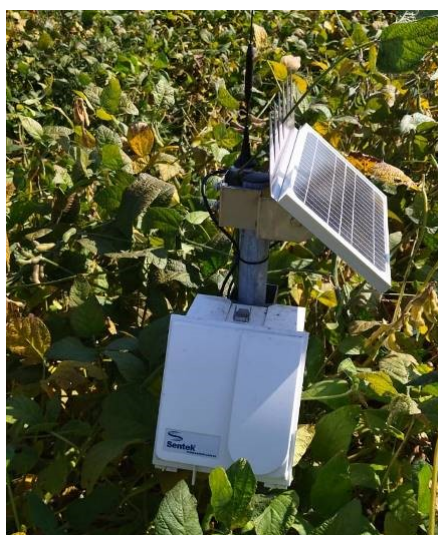
Рисунок 2 – Датчик влажности почвы фирмы Sentek на посевах сои, 2023 г. (автор фото Г. Т. Балакай)
