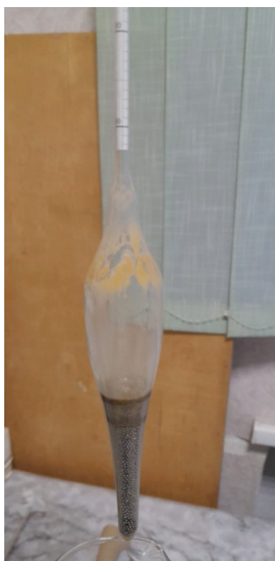
Рисунок 2 – Внешний вид ареометра после проведения опыта с почвенным образцом, отобранным с глубины 40–60 см (фото Н. Е. Волковой)
