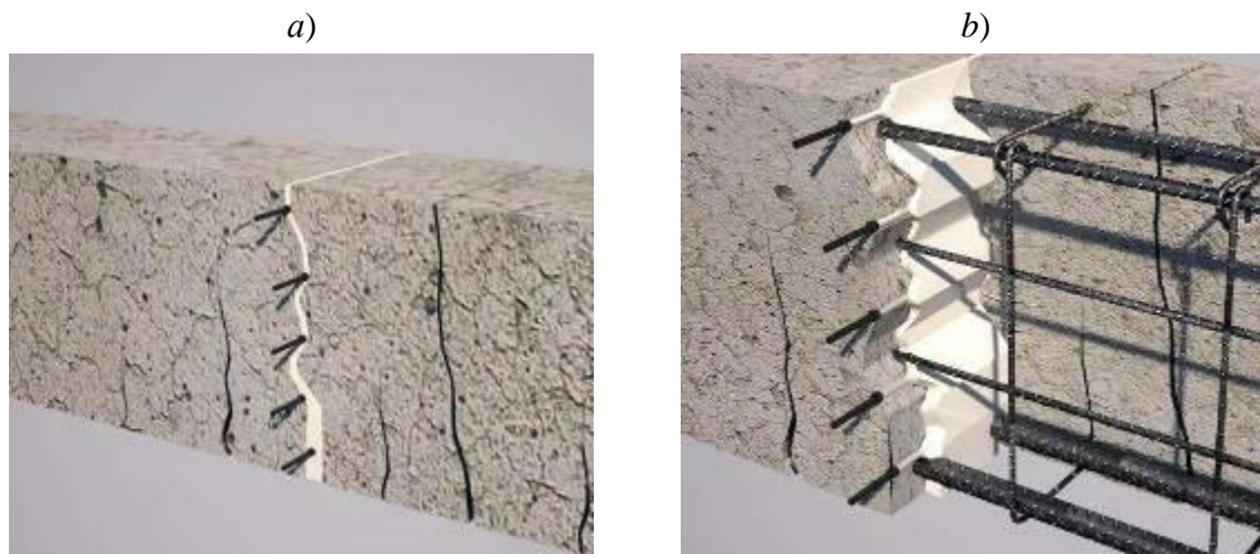
a – общий вид нагнетаемого ремонтного материала через установленные иньекторы; b – заполнение повреждения ремонтным составом через иньекторы в разрезе a – general view of the injected repair material through the installed injectors; b – filling the damage with repair compound through injectors in the section
