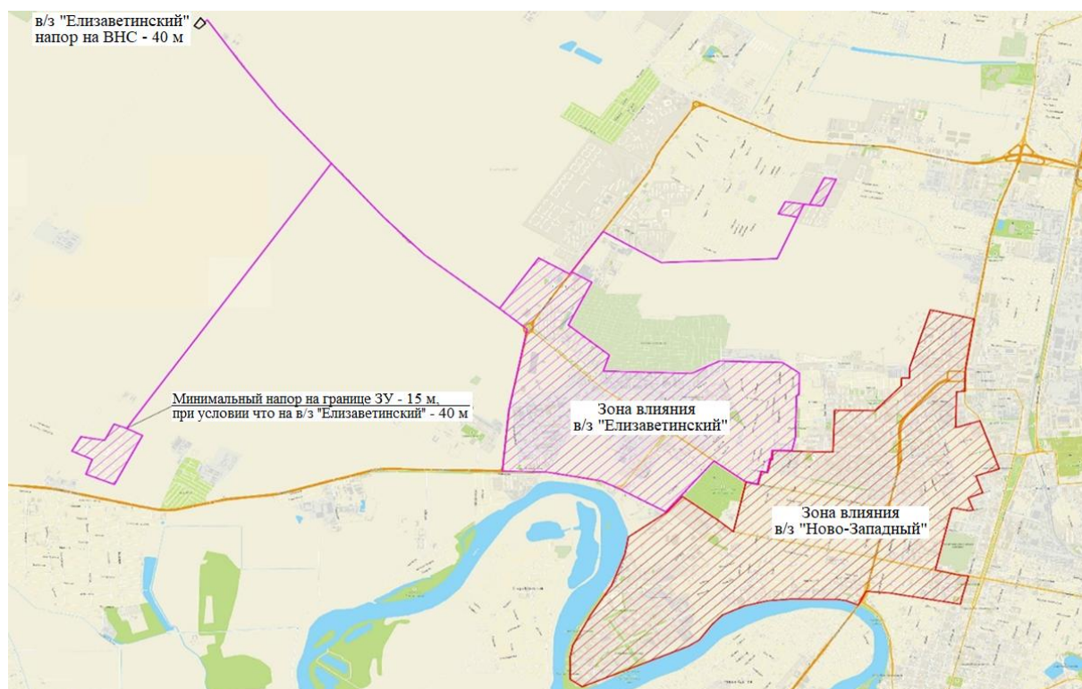
Рисунок 2 – Зоны влияния водозаборов «Елизаветинский» и «Ново-Западный» Figure 2 – Influence zones of the Elizavetinsky and Novo-Zapadny water intakes
